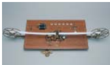
図 12 エンボッシング・モールス 電信機 レプリカ 当館蔵
