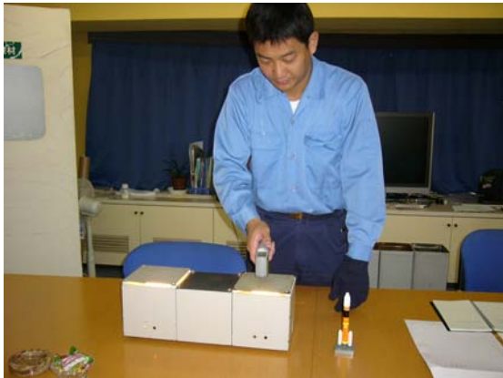
写真 34 ガイナを塗った資料の温度測定
