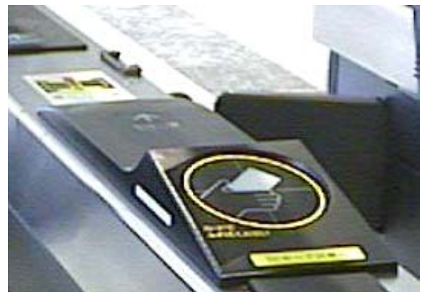
写真3 「リーダ/ライタ」部分 (提供・JR東日本)
