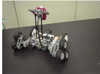
図4 Bチーム 階段荷物運び介助ロボット
