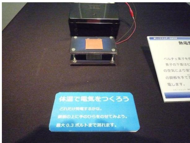
図 8 熱電発電装置(ヤマハ㈱)
