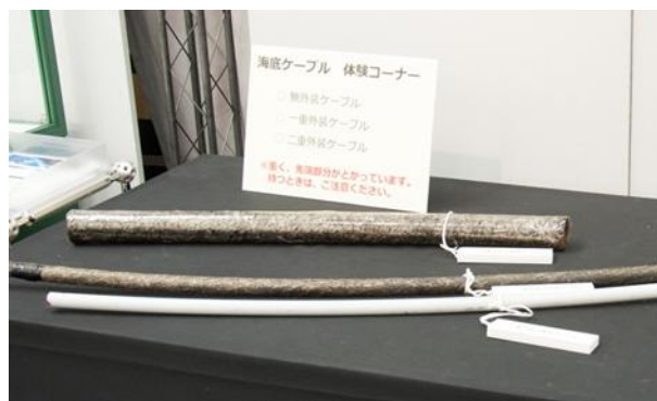
図 7 触れられる光海底ケーブル
