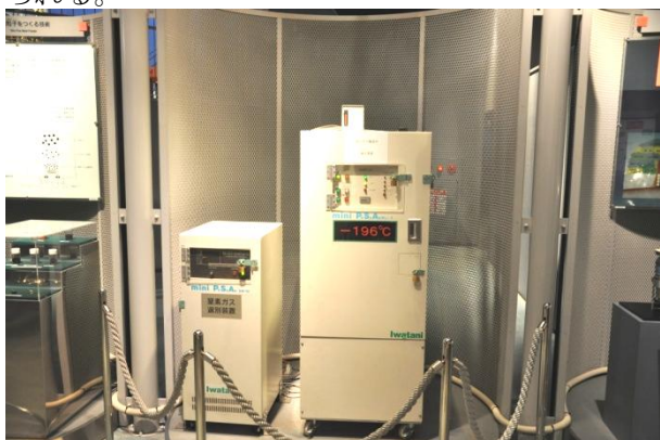
図5 液体窒素製造装置
