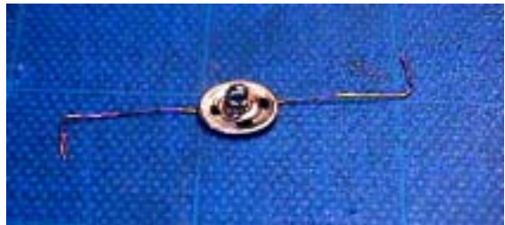
（写真 2）銅線を曲げて完成した回転子 回転子を で作った台の針金の先に上から乗せてでき上がりです。
