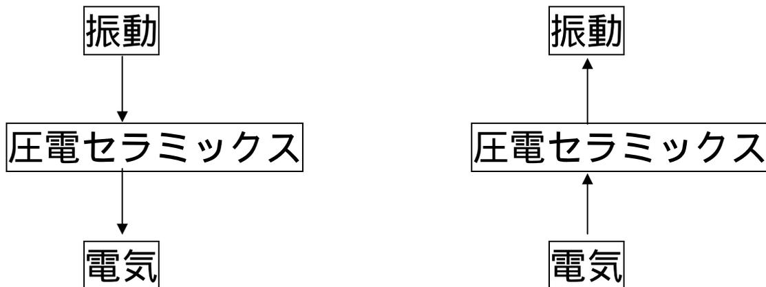
圧電性を持つ物質としては、古くからロッシェル塩や水晶の単結晶が知られています。圧電セラミックスは、ジルコン酸チタン酸鉛やチタン酸バリウムなどの「強誘電性」を持つ物質を高温で焼き固めたものです。このままでは圧電性を示しません。セラミックスのブロックに高い直流電圧をかけると、バラバラの電荷の向きが一方向に揃います。そしてひとたび電荷の向きがそろると、電圧を解いても元に戻らなくなります。これを「分極処理」といいます。
