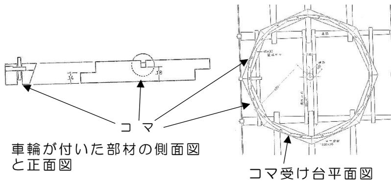
車輪が付いた部材の側面図と正面図
