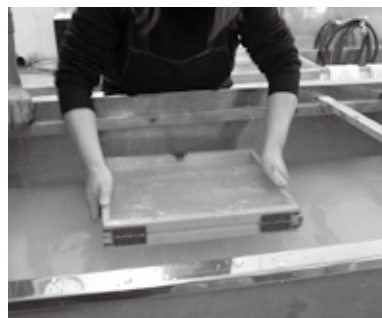
白皮とネリを水にまぜて、けたす桁と簾で漉きます。干し板にはって乾くとできあがり。
