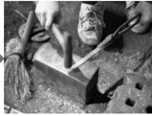
熱くした鉄を槌でたたいて形を作ります。
