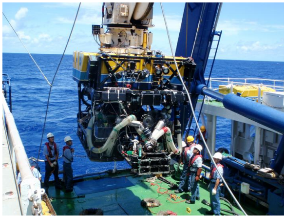
無人探査機「ハイパードルフィン」。「なつしま」船尾から出し入れされます。
