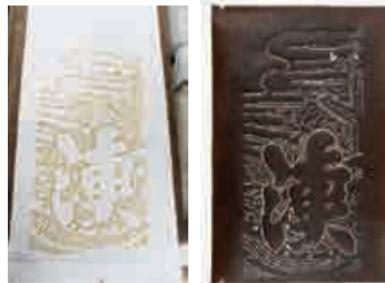
型付糊をデバベラで置いていく。糊の量の調整は、糊をとった段階でヘラをまわして余分な糊を落としておこなう。糊を置いたら、型紙を手前から上にあげて外していく。外した型紙は元の板の上に戻し、次の型紙の型付をする前に手についた糊を布で拭き、次の工程に支障が出ないようにする。作業の合間には型紙が乾燥しないように、適宜霧吹きや布で型紙を湿らせる。型付が終わったら、生地の表に伸子を三十 cm から四十 cm 幅でさして室外に移動して干す。型付の終わった型紙は水に浸けて糊を落とす。
