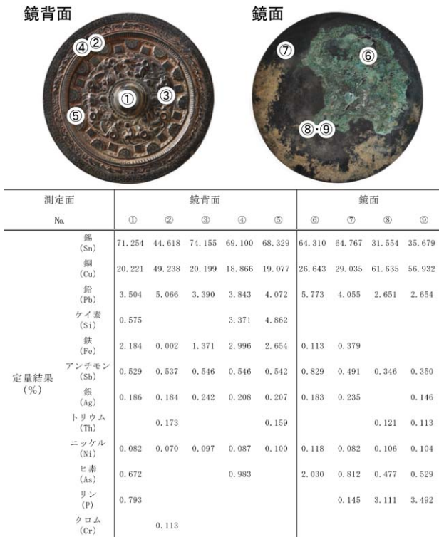
【蛍光 X 線分析の計測環境】 SHIMADZU EDX-8100 (東京都埋蔵文化財センター) ターゲット Rh、管電圧 50kV、管電流 1000 \mu A (auto)、測定時間 30sec コリメータ: ①・⑥~⑨10mm、④・⑤1mm、他 3mm 解析範囲 0.00 ~ 35.00eV、FP 法
