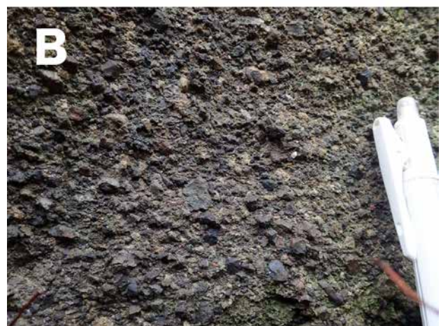
図15. 火山礫凝灰岩。A：標本全体。B：近接写真（角張った礫の集合体）。
