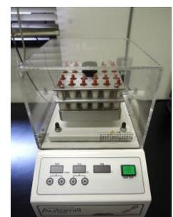
開発した環境 DNA 濃縮ステリベクスフィルター専用アダプタを装着した破碎装置
