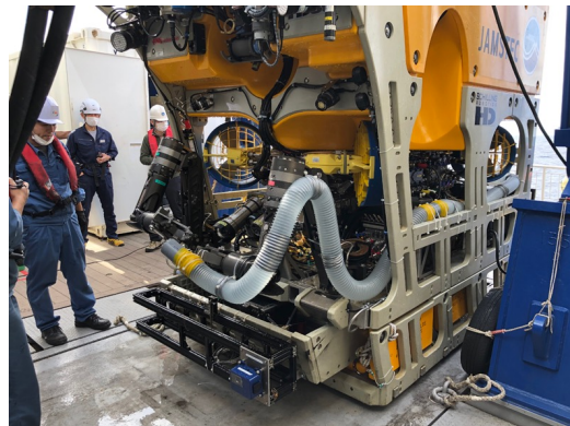
KM ROVの前面。ホースのようなものはサクシオンサンプラーの一部。これを使って生物を吸い取る。
