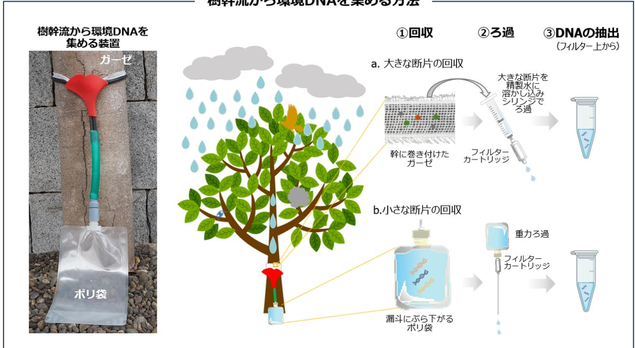
図 1. 樹幹流から環境 DNA を集める方法。① 地衣類の体の一部など大きな断片をガーゼ上に回収し、樹幹流に含まれる DNA など小さな断片をポリ袋に回収する。② 回収したガーゼと樹幹流から地衣類の体の一部や DNA をそれぞれカートリッジの中にあるフィルター上に集める。③ フィルターから環境 DNA を抽出する。
