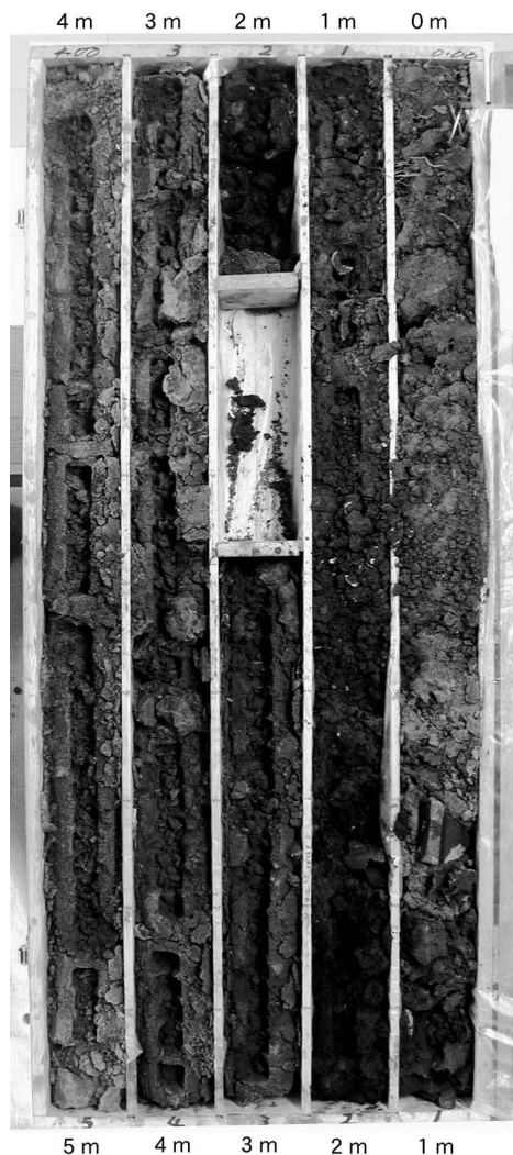
図4. Tb コア上部5 m の堆積物写真. 深度2.2 ~ 2.5 m は欠落.
