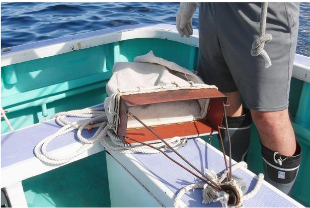
図1. 採集に用いられたドレッジ。開口部の幅は40 cm.
