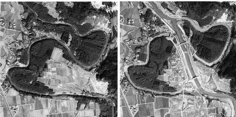
写真5.1 養老川の蛇行部分の川廻し(左:改修前,右:改修後)
