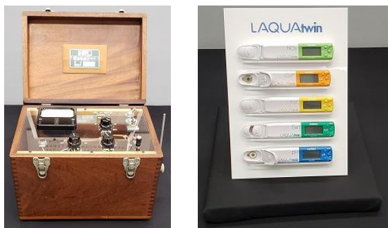
左図 30 ガラス電極式 pH メーターのスケルトン模型 右図 31 LAQUAtwin
