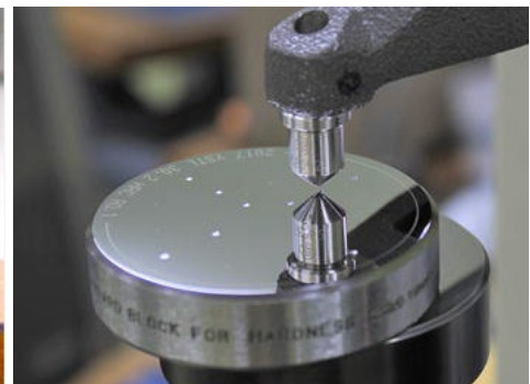
基準片を使った硬さ試験機の検査
