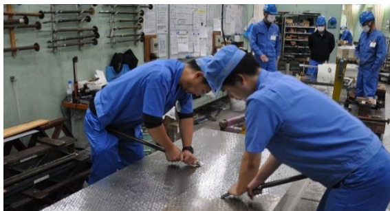
「キサゲ技術」による精密定盤の加工
