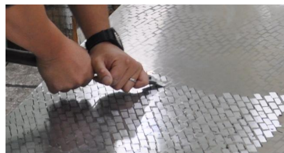
「キサゲ加工」を施した定盤表面
