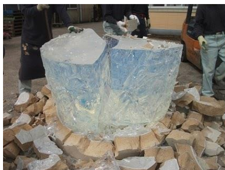
ルツボよりガラス取り出し
