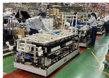
組立ライン AGV (自動搬送車)
