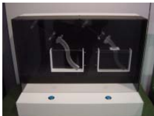
図 17 屈折率と全反射についての説明装置
