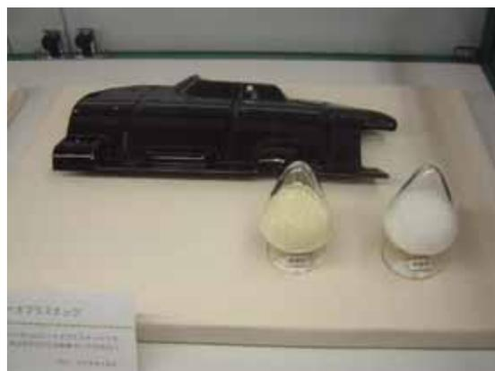
図 バイオプラスチックの製品と原料
