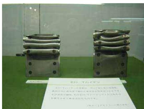
図 BHTハイテン落重試験片
