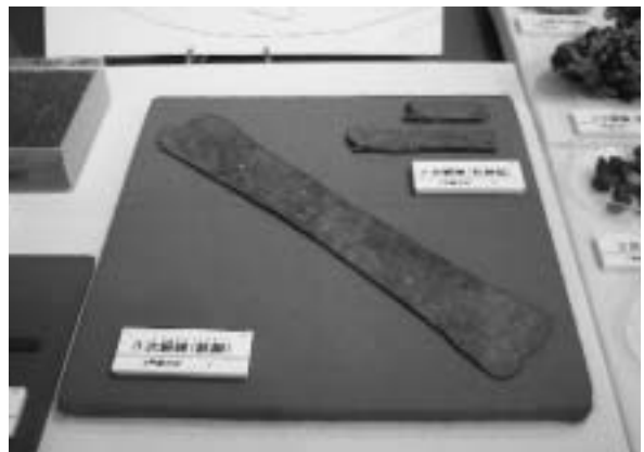
図4 3次鍛錬（鉄錠）、2次鍛錬（粗鉄錠）
