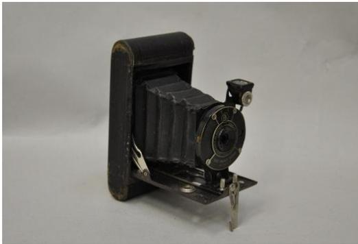
「ベストポケット・オートグラフィック・コダック モデルB」(図9)は1925年発売のベスト判クラップカメラ。ロールフィルム127フィルム(ベスト判画面サイズ4×6.5センチ)を使用した小型軽量のベストポケット・コダックは1912年に発売され爆発的に売れた。オートグラフィック方式は専用フィルムと裏紙の間にカーボン上の薄紙を挟み、裏ぶたの小窓を開いて付属の鉄筆で上書きすると文字が露光されて記録されるしくみである。
