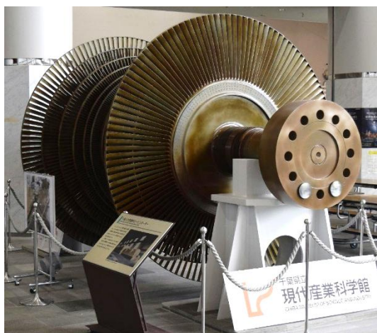
図1 タービンローター(実物)
