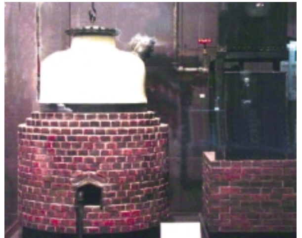
ねつぶんかいそうち パートンの熱分解装置（模型） パートンの熱分解装置により、同じ量の石油から今までよりも多くのガソリンが得られるようになりました。
