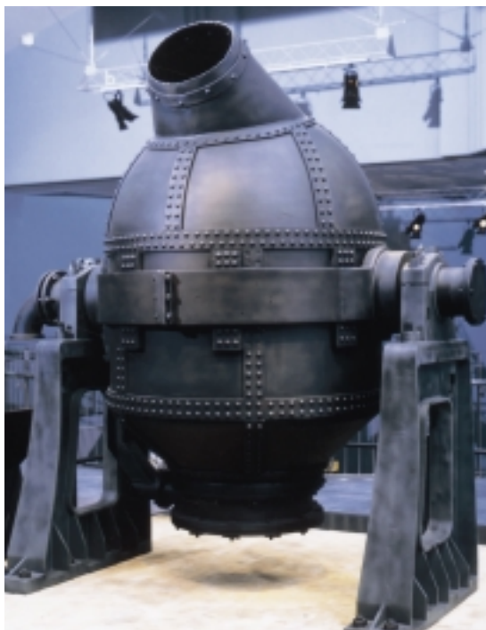
ベッセマー転炉（模型） ベッセマー転炉により人類は初めて大量の鋼を生産できるようになりました。1856年のことでした。
