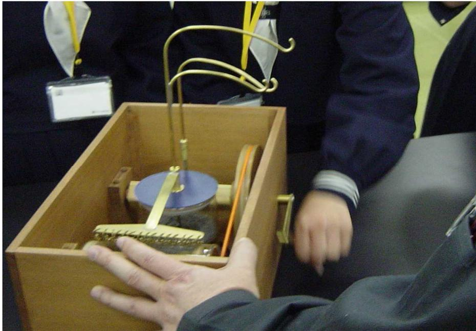
ガラス円筒(回転部分)の表面が汚れることが起電性能に与える影響が最も大きいので以下の点に注意してください。
