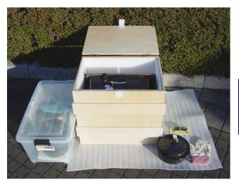
反射鏡が折りたためて簡単に持ち運ぶことができます。収納ケース(W630×D480×H545mm)に、鍋と鍋つかみ、太陽の反射光から目を守るためのサングラスをセットして貸し出します。 (1 ケース約 21.5kg)
