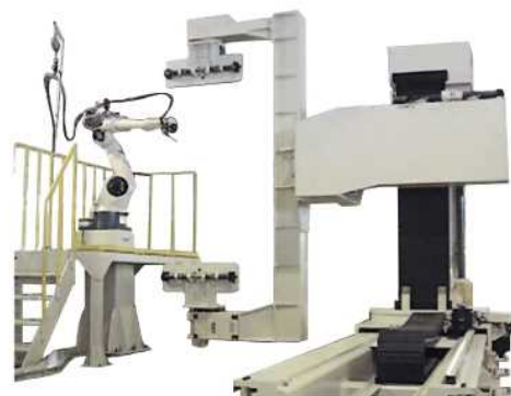
写真2 LINEMAN+溶接ロボット
