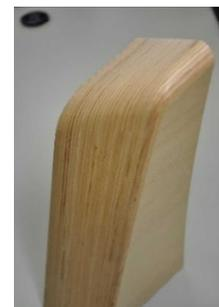
写真3 脚部のカットモデル
