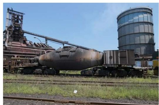
日本製鉄の混銑車(トーピードカー)
