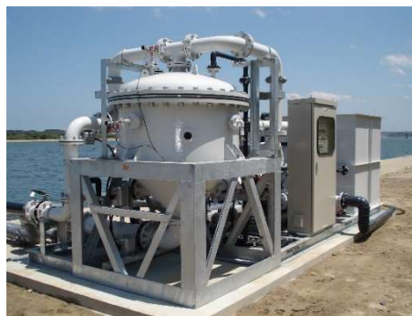
写真2：バラスト水ろ過システム
