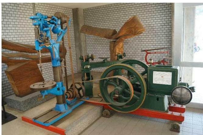
写真3：直立ボール盤と動力部
