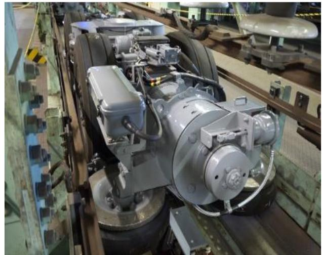
写真2：電動装置と案内輪・走行輪
