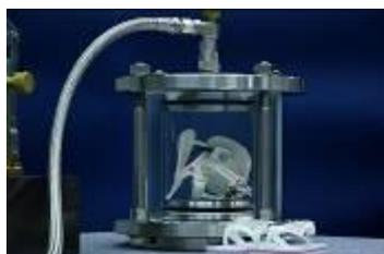
図11 加圧実験水槽
