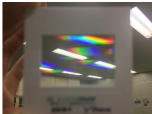
図18 回折格子を通して蛍光灯を見た様子
