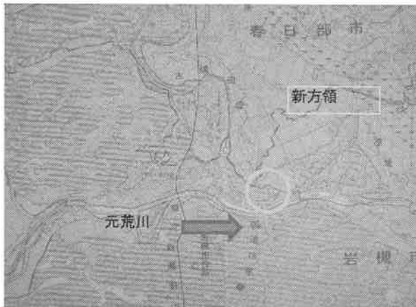
図-1 岩槻のおっぼり位置図 岩槻おっぼりは、この図から見ると古隅田堤の西側、 すなわち古隅田川の旧流路跡に位置しており、 厳密には洪水破堤後の押堀ではないことになる。 (元図: 江戸川工事事務所・治水地形分類図) (市川が加工・抜粋)
