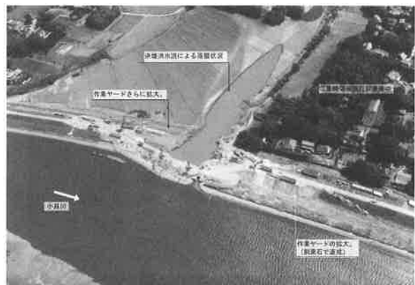
写真-4 昭和56年小貝川左岸高須地先破堤の「おっぼり」(ロケット火炎型) 写真:利根川下流河川事務所提供
