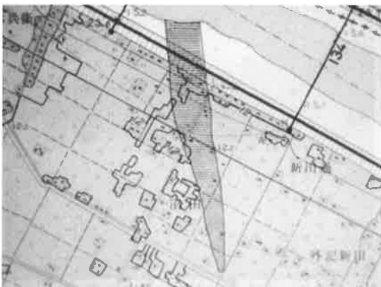
図-4 治水地形分類図 カスリーン台風による新川通破堤箇所の「おっぼり」跡(長さ1km、ロケット火炎型)
