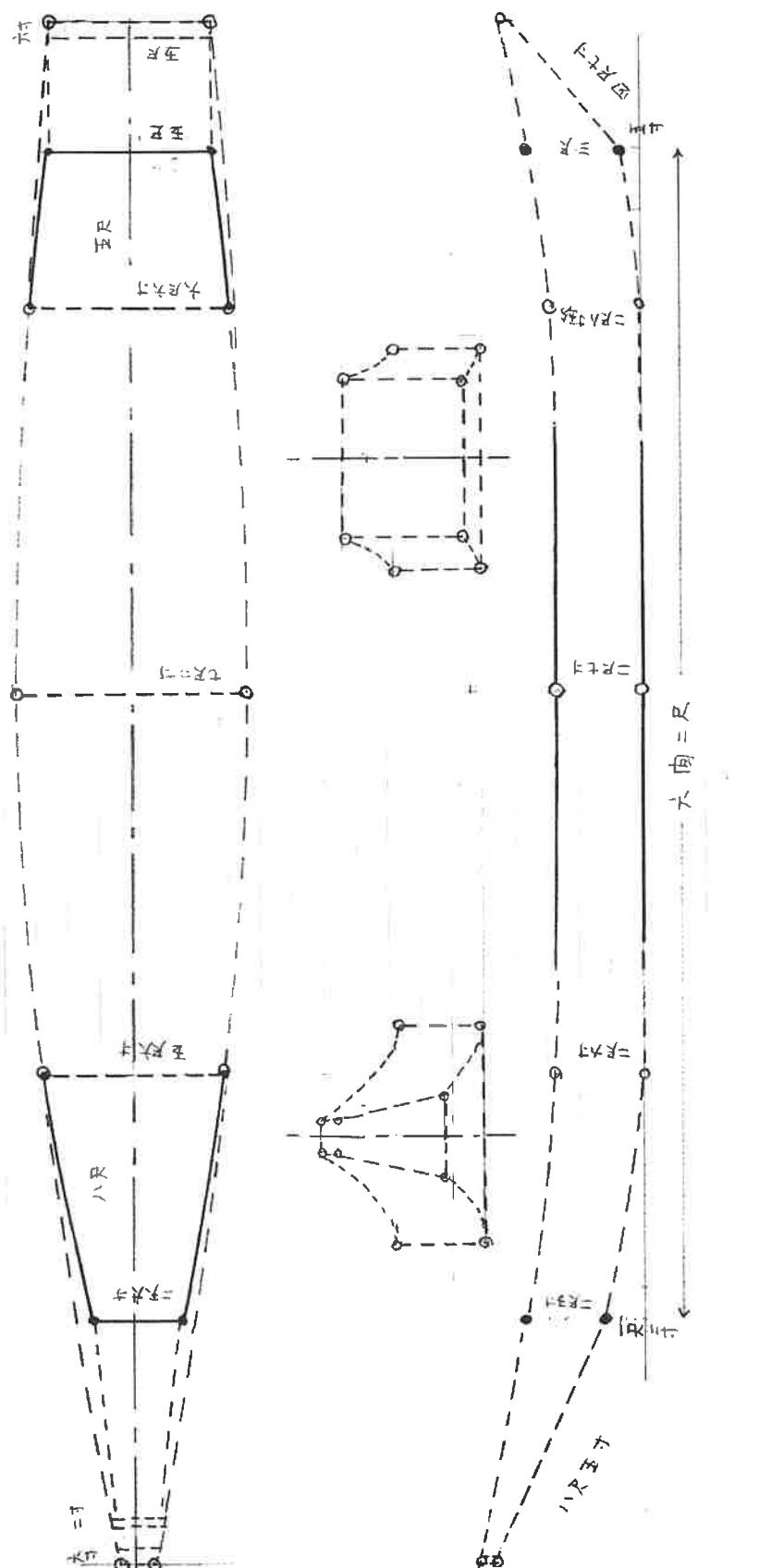
図8 吉井川の高瀬船推測船図
