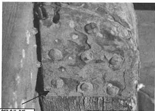
上小縁裏側。上小縁釘破断面。断面扁平な釘が、錆びて膨張し、断面正方形になる。このことから、出土遺物解析時、釘孔の形状判定に注意しなければならないことがわかる。
