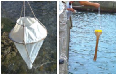
プランクトンネット（左）と女性用ストッキングで作した簡易プランクトンネット（右）。
